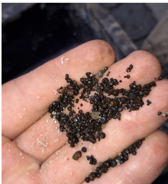
Rys. 2. Piasek kwarcowy: a) stary, b) nowy (fot. Marcin Kos)
