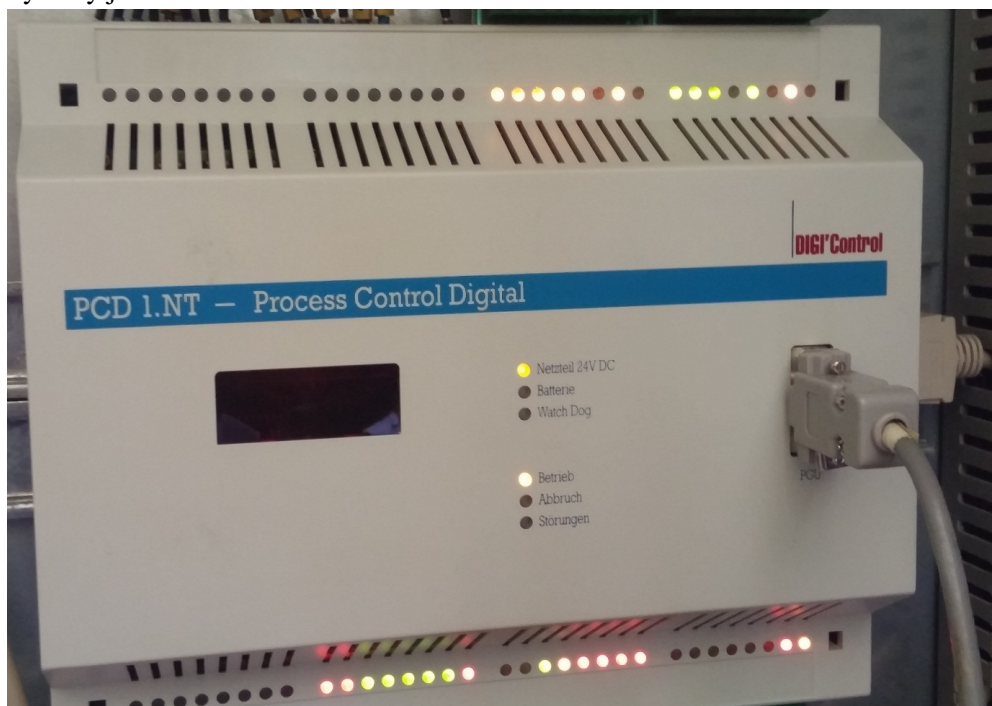
Rys. 3 Sterownik Wykorzystywany do sterowania SUW Zaborze
